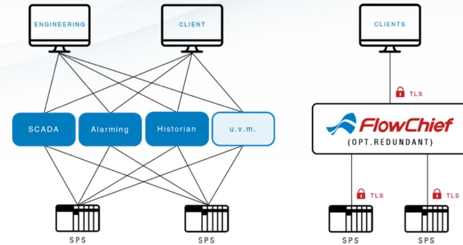
In Leittechnikumgebungen finden sich häufig diverse Produkte unterschiedlicher Hersteller (z.B. SCADA, Alarmierung, Historian, Energiemanagement). FlowChief bietet eine umfassende Lösung, die dieses Spektrum in einer einzigen Plattform vereint. Weniger Systeme bedeuten weniger Kommunikationsverbindungen, was wiederum den Aufwand für Sicherheitsbewertungen reduziert und die Überwachung vereinfacht.
